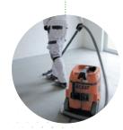
LUFTREINIGER müssen so platziert werden, dass sich die Ansaugöffnung in der Nähe der Staubquelle befindet, siehe auch die Herstellerangaben.
