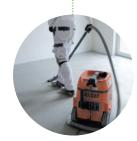
I DEPURATORI DELL'ARIA devono essere posizionati in modo che l'apertura di aspirazione sia vicina alla fonte di produzione della polvere (si vedano anche le istruzioni del produttore).
